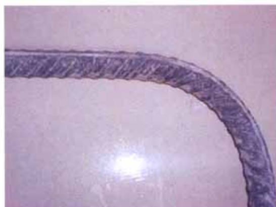
میلگرد گالواتور پس از گذشت ۴۸ ساعت از زمان آزمایش
