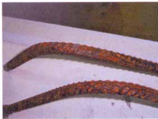
میلگردهای کربن استیل پس از گذشت ۴۸ ساعت
