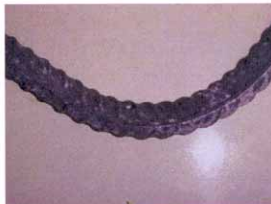
میلگرد گالواتور پس از گذشت ۴۸ ساعت از زمان آزمایش
